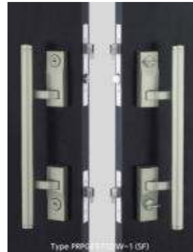
Model/ Mã số PGF571DW(SF) Material Die-cast aluminum Chất liệu Nhôm đúc Finishes Stainless color painted Hoàn thiện Sơn chống gỉ Size (mm) 95x450 mm(RxD) Application 36-45mm door thickness range Ứng dụng Độ dày cửa 36-45mm
